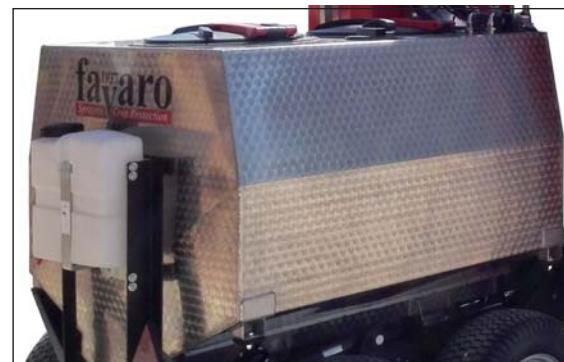
**■** L'irroratore a tunnel con Recupero **BACCO** è dotato di una cisterna da 1000 e 1500 litri in acciaio inox AISI 316. La cisterna ha all'interno anche un serbatoio di acqua pulita da 120 litri per il lavaggio del circuito. Inoltre all'interno della cisterna c'è anche un separatore per l'acqua.
